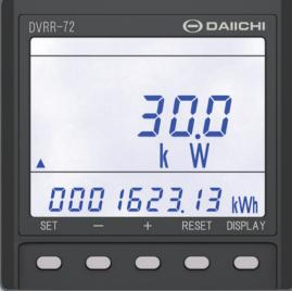
GROUND OVERVOLTAGE & REVERSE POWER PROTECTION DEVICE
