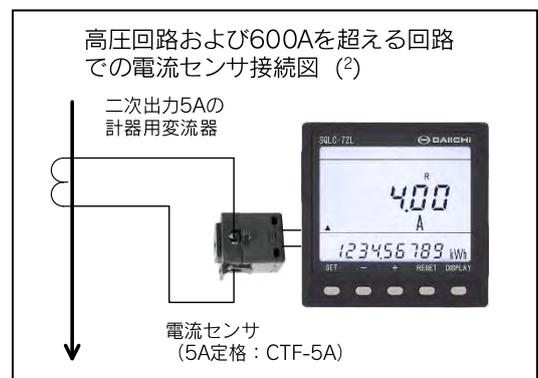
注(4) 計器用変圧器 (VT) 及び二次定格5Aの計器用変流器 (CT) を使用し、二次側を接地してください。
