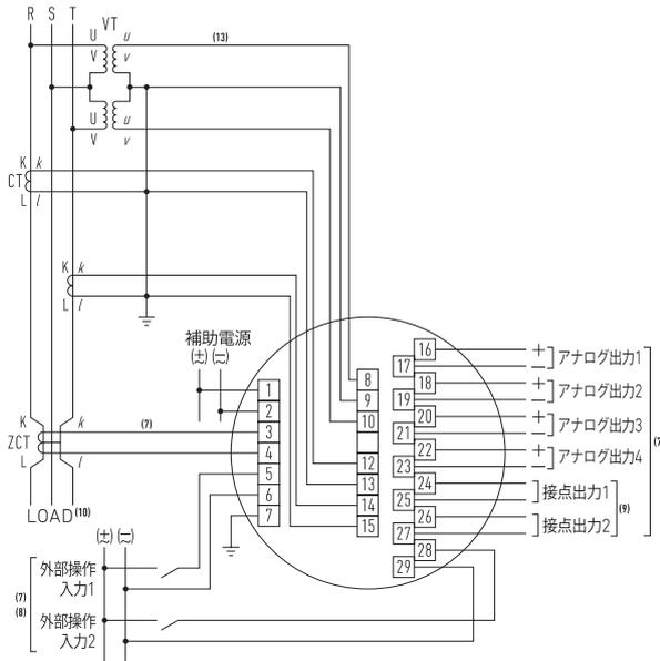
● 漏電監視でZCTを接地線に取り付ける場合
