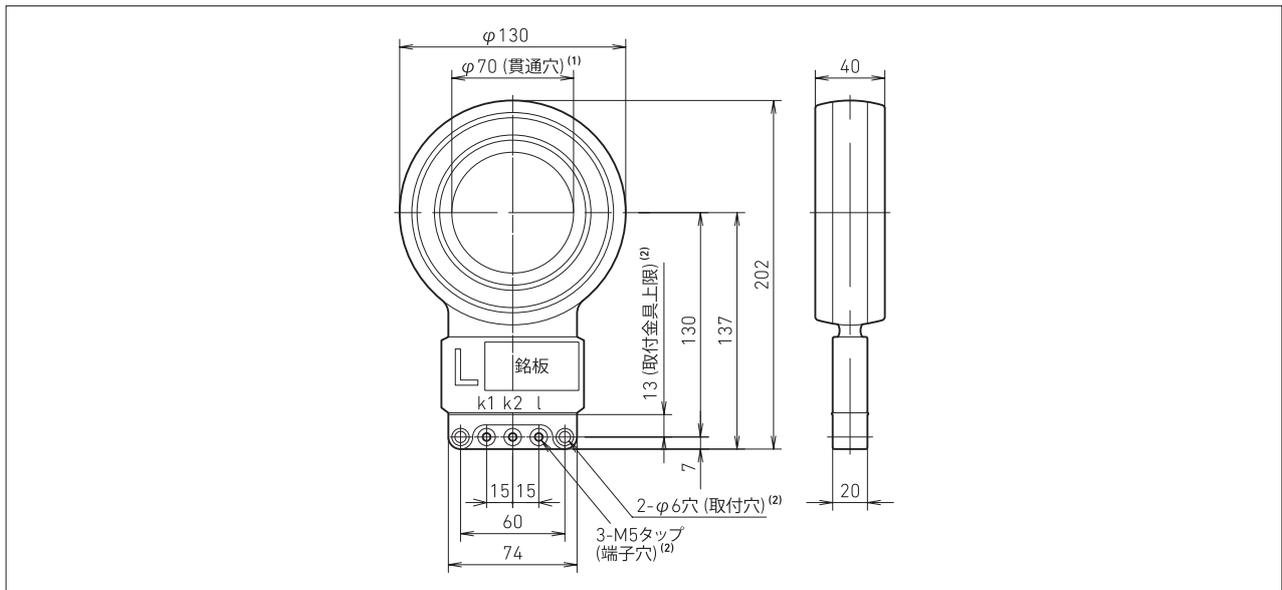
注 (1) 貫通導体は貫通穴の中央に配置してください。また、変流器外装との距離を10mm以上確保してください。
