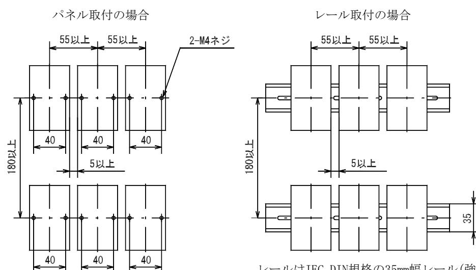
レールはIEC、DIN規格の35mm幅レール（強化型）をご使用ください。
