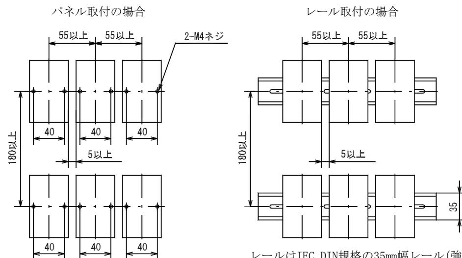
レールはIEC, DIN規格の35mm幅レール(強化型)をご使用ください。
