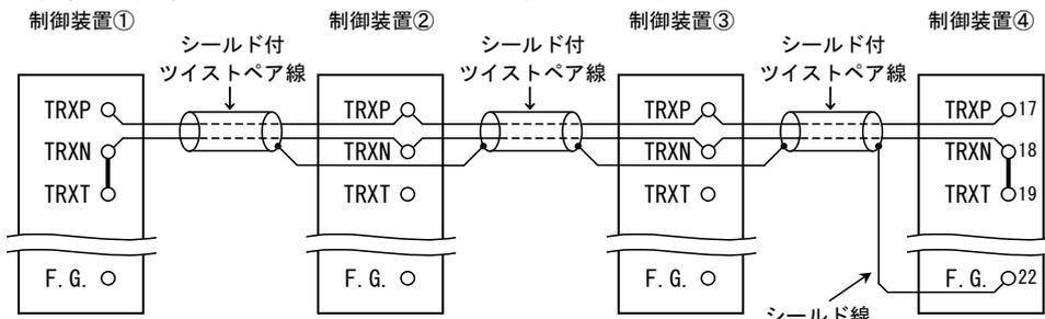
(1) 各制御装置間の通信 TRXP、TRXN 同士を上図の様にシールド付ツイストペア線にて接続します。
