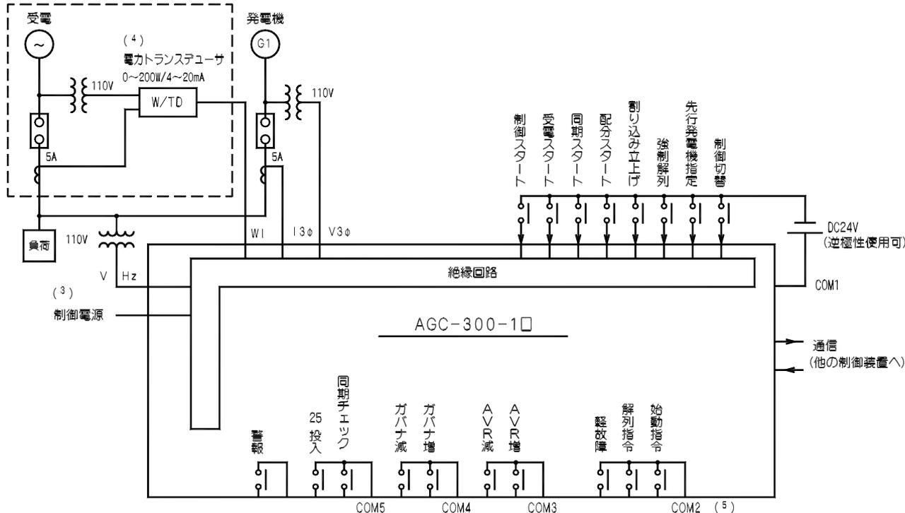
注<sup>(3)</sup> 制御電源 DC100/110V, AC100/110V 50/60Hz または DC24V に対応可能です。
