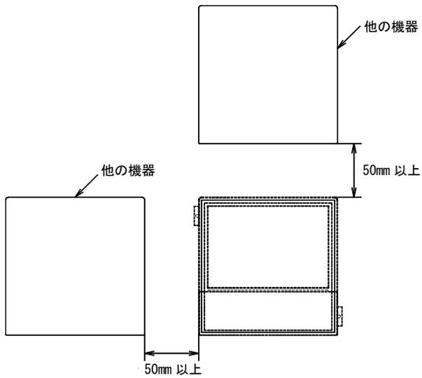
空気の自然対流による放熱を考慮して他の機器と 50mm 以上の空間距離を設けてください。
