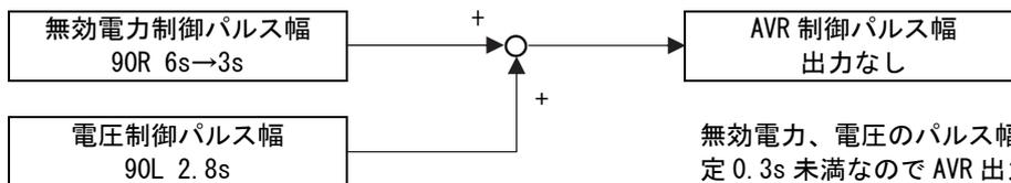
無効電力、電圧のパルス幅の計算結果が最小パルス時間の設定 0.3s 未満なので AVR 出力はなしとなります。
