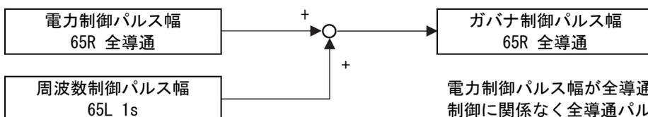
電力制御パルス幅が全導通パルスとなっているため、周波数制御に関係なく全導通パルスが出力されます。
