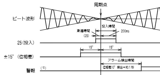
注<sup>(12)</sup> 警報は同期投入ミスが投入出力継続回数 25N(1~3)後に発生した場合、出力します。投入出力継続回数設定が無制限の場合は出力されません。警報出力のリセットは、同期スタート入力を OFF にすることで行われます。
