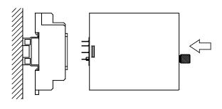
(4) ソケットを外す方法 ソケットのスライダーの溝にドライバーを差し込み、 図の矢印方向に引きながらソケット下部を手前に引い て外してください。
