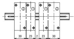
レールはIEC, DIN規格の35mm幅のレール(強力型)をご使用ください。推奨品》富士電機㈱ TH35-15AL
