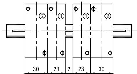
レールはIEC, DIN規格の35mm幅のレール(強力型)をご使用ください。
