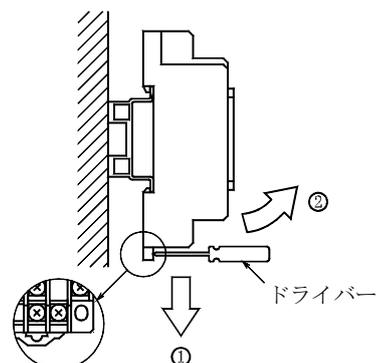
〈注意〉 トランスデューサ本体を斜めに抜き差しすると本体の端子が曲がり、ソケットとの接触不良などの障害の原因となります。
