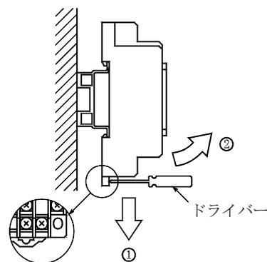
〈注意〉 トランスデューサ本体を斜めに抜き差しすると本体の端子が曲がり、ソケットとの接触不良などの障害の原因となります。
